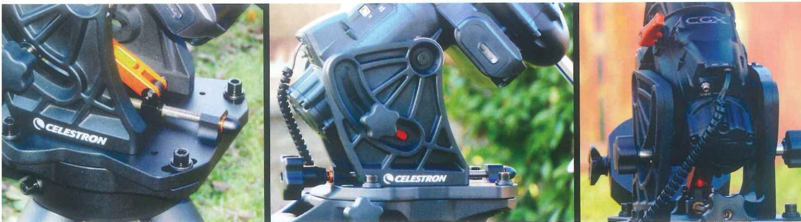
↑ Il piatto di appoggio della montatura ha un diametro di 160 mm. Il movimento per la regolazione in altezza dell'asse polare è precisissimo; tutte le viti con testa a brugola servono per la regolazione e il settaggio. Non è previsto un cannocchiale polare, perché l'allineamento al polo è assistito dal software; sul lato posteriore la presa di alimentazione e due porte Aux.
