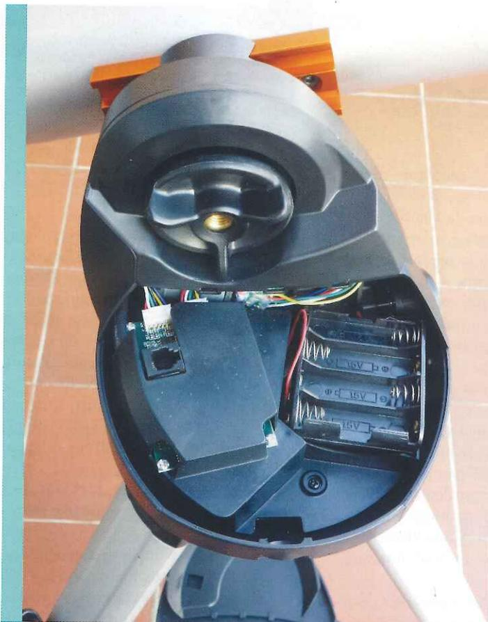
► Ecco come appare il blocco montatura una volta estratto il coperchio. Si noti il vano batterie.
