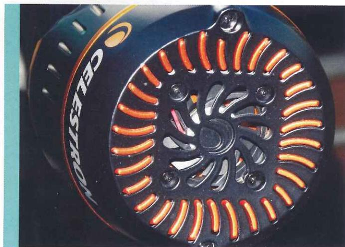
La ventola estrattrice del calore prodotto dal raffreddamento termoelettrico non ha grandi dimensioni, ma è efficiente e permette di abbassare la temperatura del sensore di 20 °C rispetto all'ambiente. Belli e colorati gli inserti arcuati che ricordano, nel colore, il tipico "arancione" Celestron.
