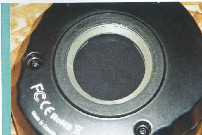
► Un buon otturatore meccanico, a banderuola, permette la completa chiusura del transito della luce in direzione del sensore: aumenta così la facilità di riprendere immagini *dark* in ogni momento della giornata.
