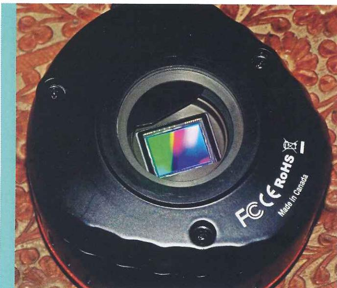
Il CCD KAF-10100 *color* è costituito da 3760 x 2840 pixel quadrati con dimensioni di 4,75 mm. In totale è un sensore da quasi 11 Mpx.
