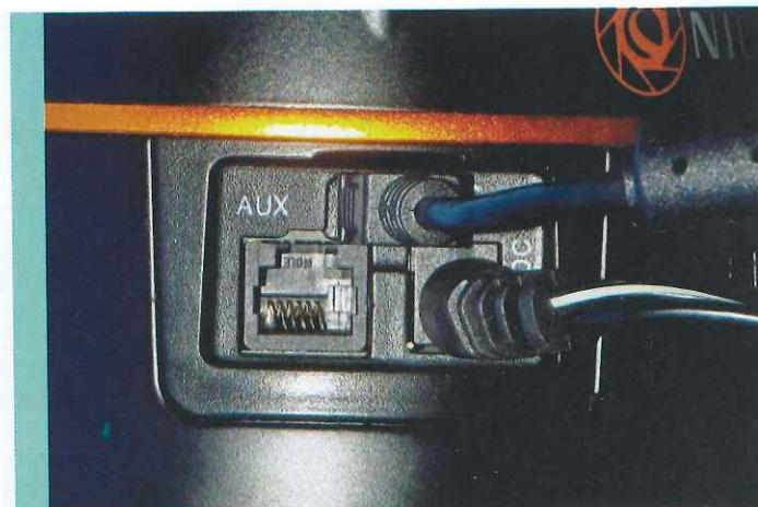
► Gli unici connettori presenti sulla camera permettono il collegamento USB con il PC, l'alimentazione a 12 V CC e una eventuale connessione AUX con jack di tipo telefonico.
