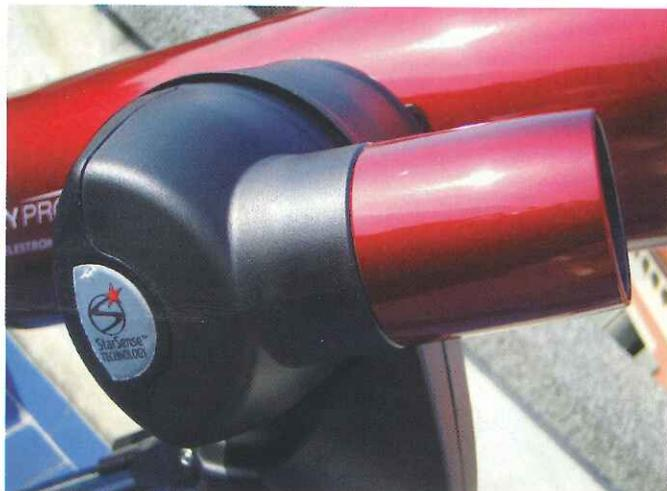
Lo StarSense è il rivoluzionario dispositivo che permette al telescopio SkyProdigy di orientarsi automaticamente senza ricorrere al GPS. Questa semplificazione apre la porta dell'astronomia anche alle persone meno esperte.
