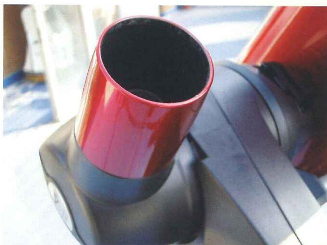
Particolare dello StarSense, la camera CCD che inquadrando alcuni campi stellari fornisce al software i dati per ricostruire il cielo visibile nel luogo e nell'ora di osservazione. Tutto questo avviene in maniera precisa e automatica.
