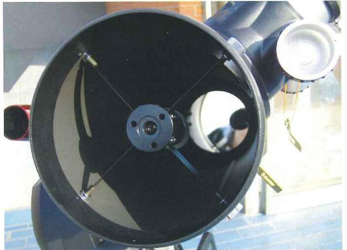
Lo specchio secondario è montato su una crociera molto sottile e robusta. Il fattore di otturazione è contenuto.
