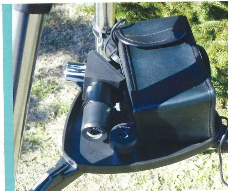
Il pacco batterie, con gli oculari; il 25 mm è inserito nel prisma.
