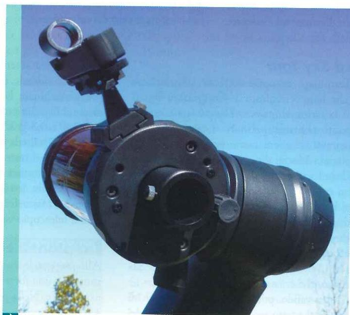
► La parte posteriore con il porta oculare da 31,8 mm.
