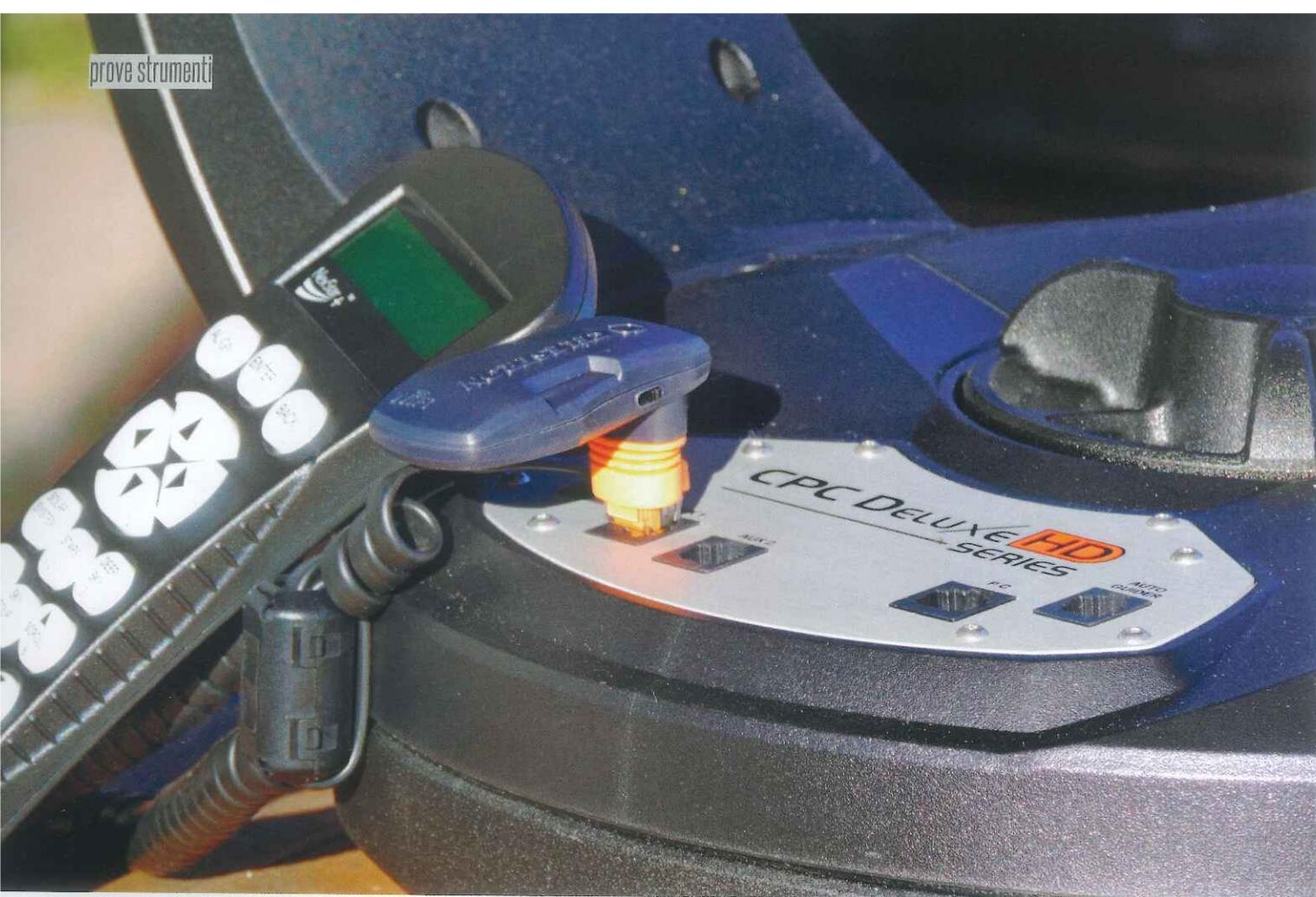
↑ La connessione con uno *smartphone* o un *tablet* avviene automaticamente via *Wi-Fi*, dopo che si è acceso il telescopio. Tre lucette che sono nascoste dietro la piccola sagomatura danno segnale dell'avvenuta connessione.
