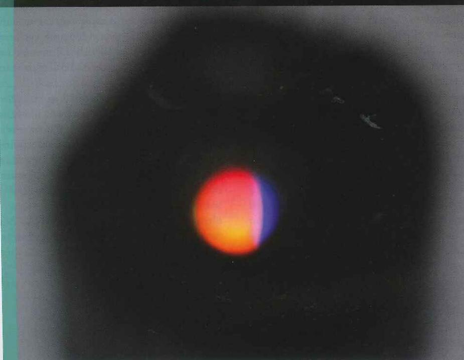
Il sensore che equipaggia la camera è un Sony ICX618ALA, con matrice monocromatica di 640x480 pixel quadrati da 5,60 micron. Si può osservare come non vi sia nessun vetrino o filtro protettivo davanti al chip; l'unico vetro presente è quello di fabbrica che copre il sensore e che permette la trasmissione dello spettro fino all'infrarosso vicino, così come è dimostrato dall'immagine di diffrazione del sensore (sotto).
