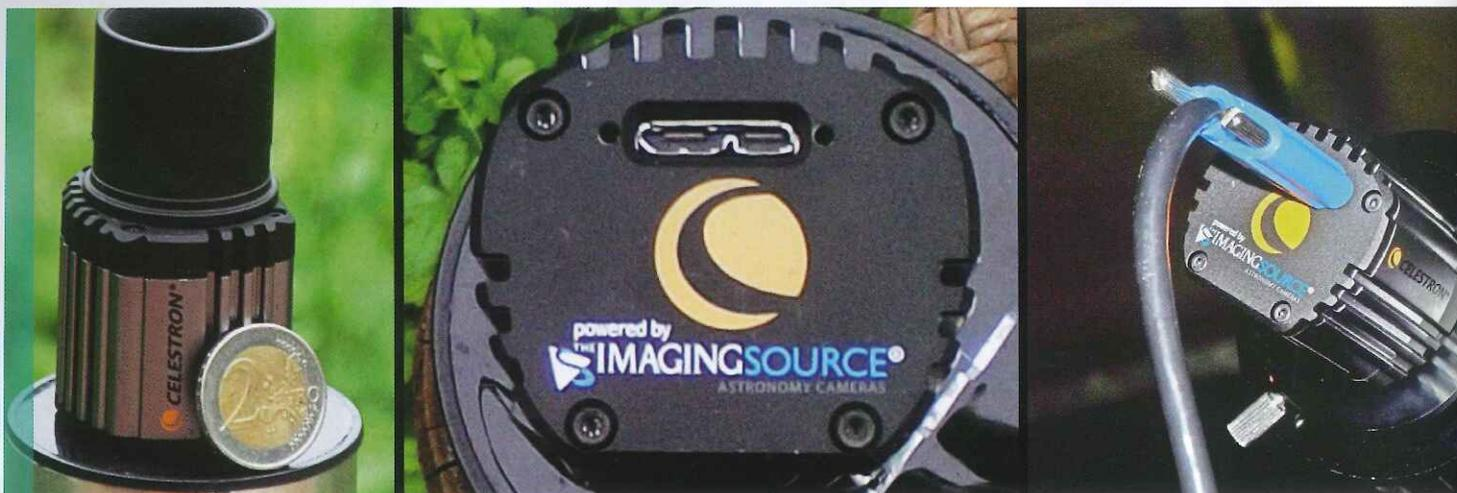
La camera CCD Celestron Skyris 618M è molto compatta, si adatta a portaoculari da 31,8 mm e pesa solo 104 g. Sul retro è presente un unico connettore per il cavo USB 3.0 che porta anche l'alimentazione alla camera; la connessione è compatibile anche con porte USB 2.0.
