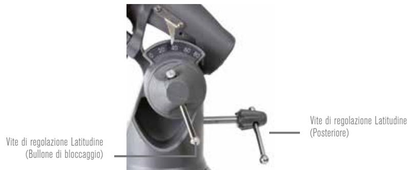
Con il livello di treppiede e l'impostazione della latitudine, l'unica cosa che rimane da fare è quella di ruotare la montatura affinché l'asse polare (l'asse AR di rotazione) punti a nord. Per fare questo:
