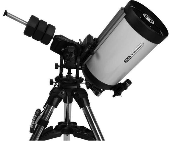
Figura 9.1 Un lato del limite meccanico di AR
