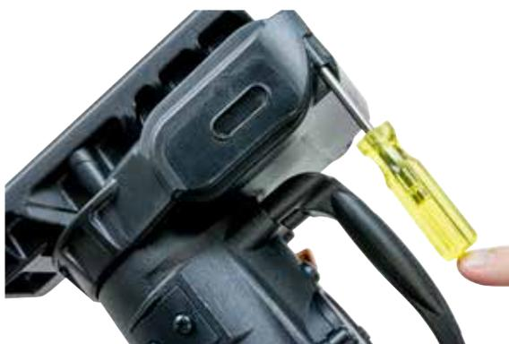
Figura 12 Rimozione della copertura della vite
