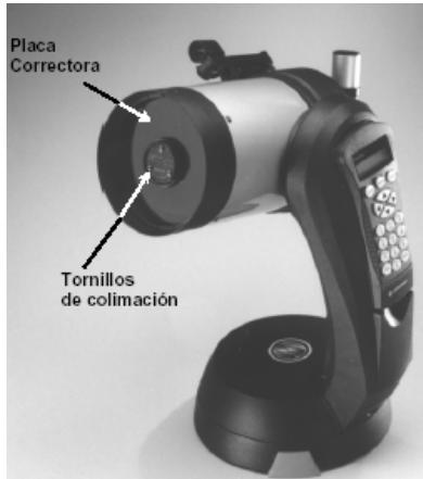
El rendimiento óptico del telescopio Celestron está directamente relacionado con la colimación, la alineación de su sistema óptico. El NexStar ha sido colimado previamente en la fábrica. Sin embargo, puede llegar a descolimarse si sufre golpes o agitaciones bruscas, especialmente durante el transporte. El único elemento óptico que puede necesitar ajuste, es la inclinación del espejo secundario.
