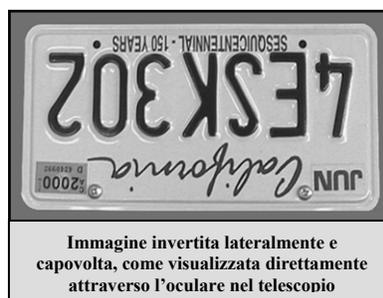
Quando si osserva attraverso i telescopi NexStar modelli 114 o 130, che sono telescopi riflettori, l'immagine sarà invertita lateralmente (immagine speculare) quando si guarda attraverso l'oculare.
