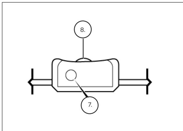
+ Il tasto otturatore (7) e la rotella di regolazione dell'illuminatore (8) si trovano sul cavo.
