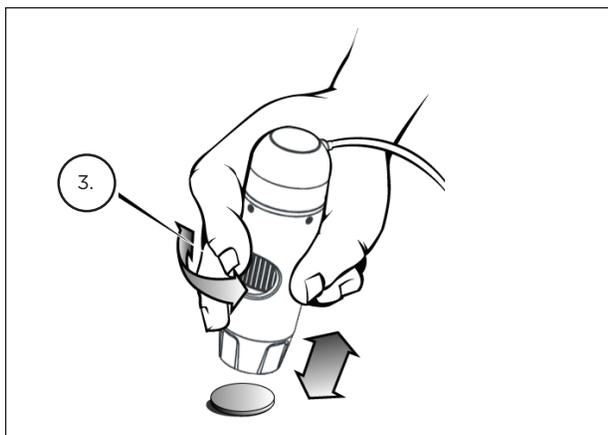
+ Quando si utilizza il microscopio in modalità portatile, regolare la messa a fuoco approssimativa modificando la distanza tra il microscopio e il soggetto. Quindi affinare la messa a fuoco utilizzando la rotella di messa a fuoco (3).
