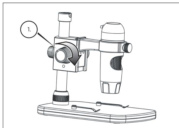
+ Una volta terminato, serrare la rotella di blocco (1), fissando la staffa in posizione.
