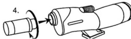
Togliete il coperchio dall'adattatore per oculare. Inserite l'oculare dello zoom con l'indicatore di potenza rivolto verso l'alto. Fissate l'oculare girando l'anello di serraggio in senso orario.
