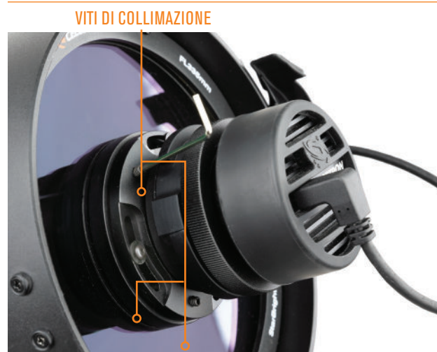
FIG. 34: Regolare l'inclinazione del gruppo lenti (e della fotocamera) con le viti di collimazione.
