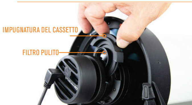
Fig. 15: Afferrare l'impugnatura del cassetto con le dita e tirare verso l'esterno per liberarlo dai magneti.
